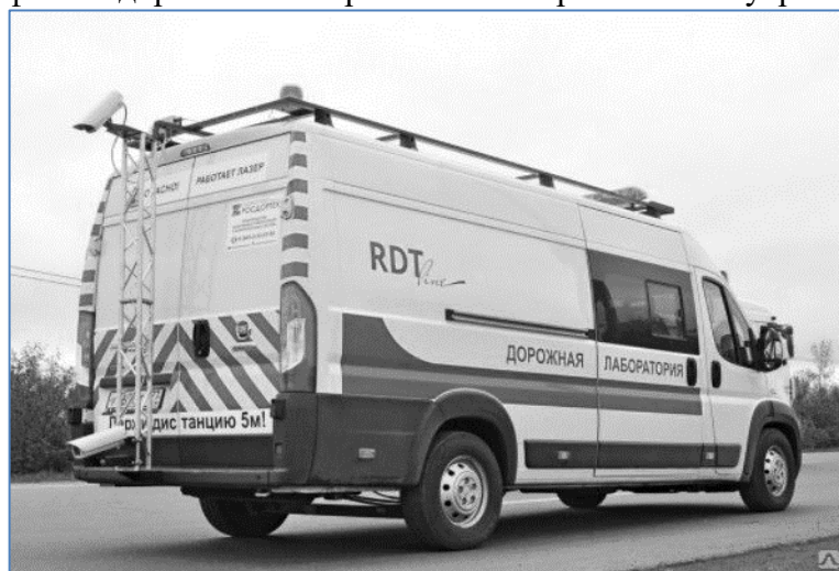
Рисунок 8 – Передвижная дорожная лаборатория КП-514 RDT
