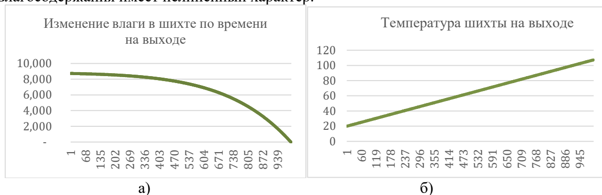
Рисунок 1 – а) – изменение влагосодержания, б) – температуры шихты на выходе из сушильной камеры
