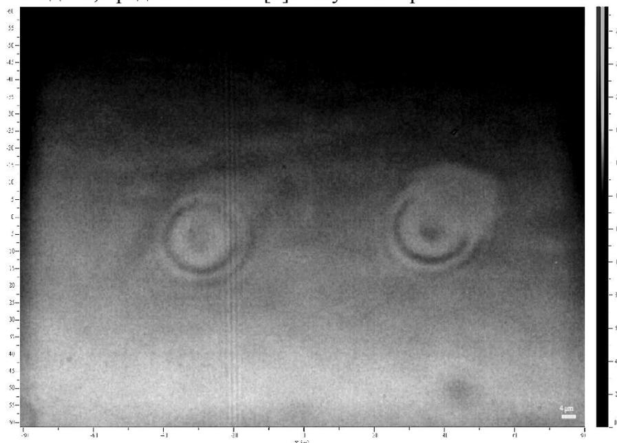
Рисунок 3. Изменение поверхностной структуры образца  $\text{Cu:H:LiTaO}_3$  в результате ФТМ
