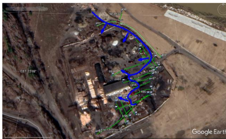
Рис. 1. Схема распространения фронта пожара по данным геолого-геофизических исследований
