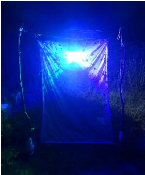
Рис. Внешний вид световой ловушки на основе светодиодной лампы LepiLED, применяемой в настоящем исследовании
