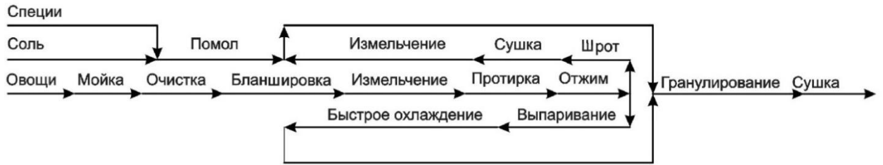
Рисунок 5.7 - Схема технологического потока производства гранулированных овощей быстрого приготовления
