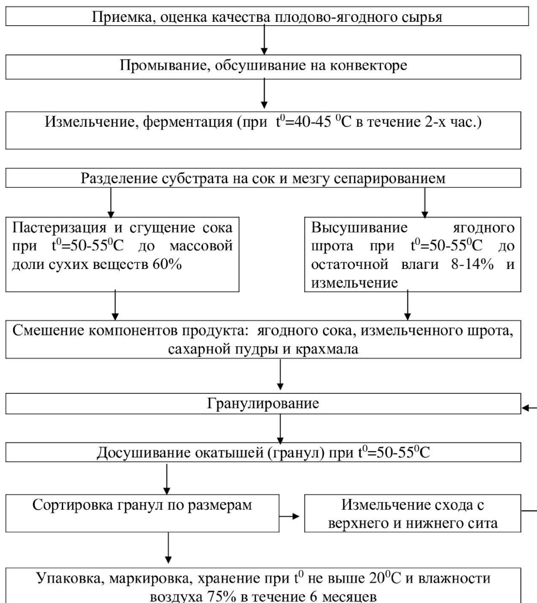
Рисунок 8.1 - Технологическая схема производства быстрорастворимого гранулированного киселя из аронии черноплодной и творожной сыворотки
