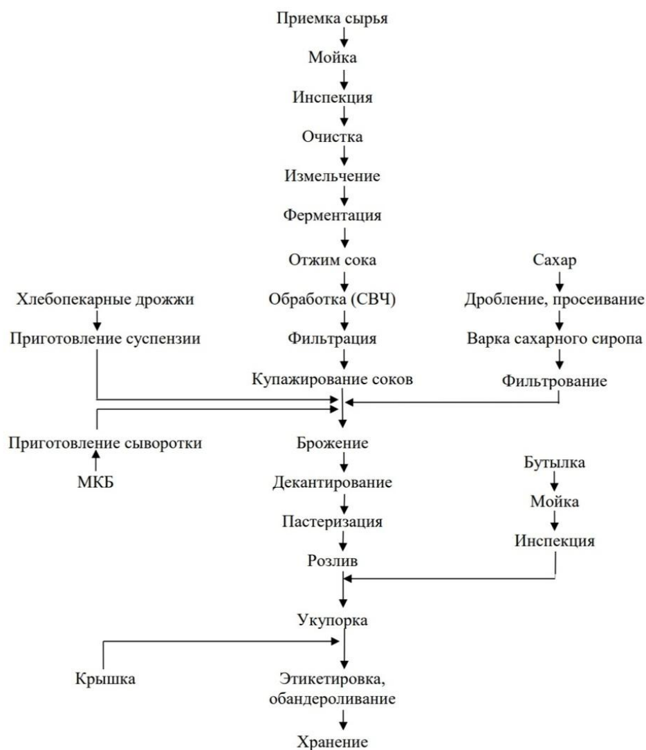
Рисунок 5.1 – Принципиальная структурная схема производства лактоферментированных овощных напитков
