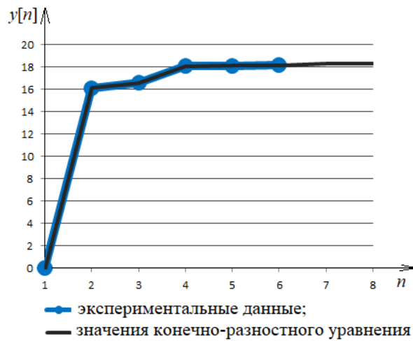
Рисунок 4.3 – Линейная аппроксимация исходных данных и полученной дискретной модели разгонной характеристики при t = 70^\circ n = 2000 \text{ мин}^{-1}
