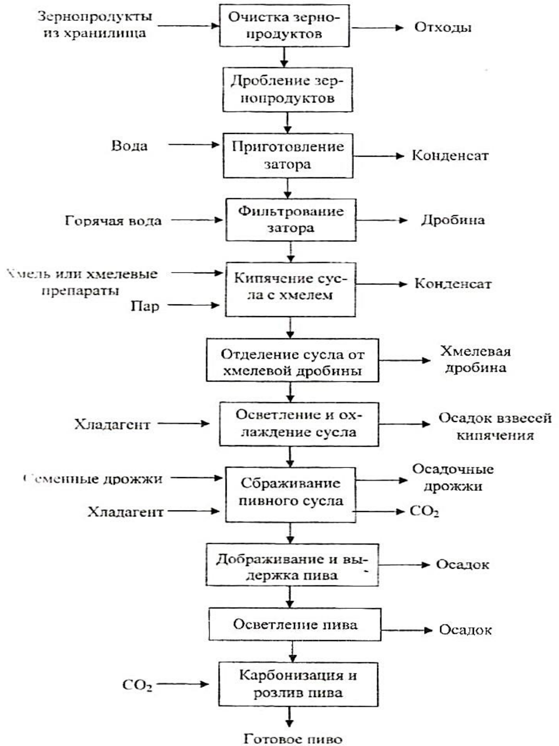
Рисунок 1.1 – Принципиальная технологическая схема производства пива
