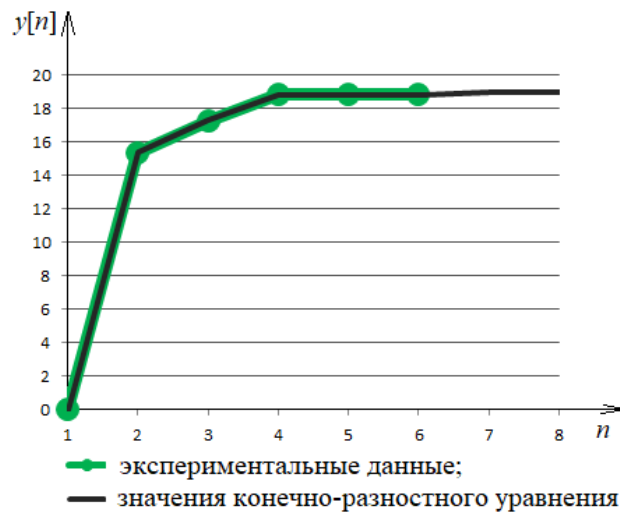
Рисунок 4.4 – Линейная аппроксимация исходных данных и полученной дискретной модели разгонной характеристики при t = 85^\circ n = 2000 \text{ мин}^{-1}
