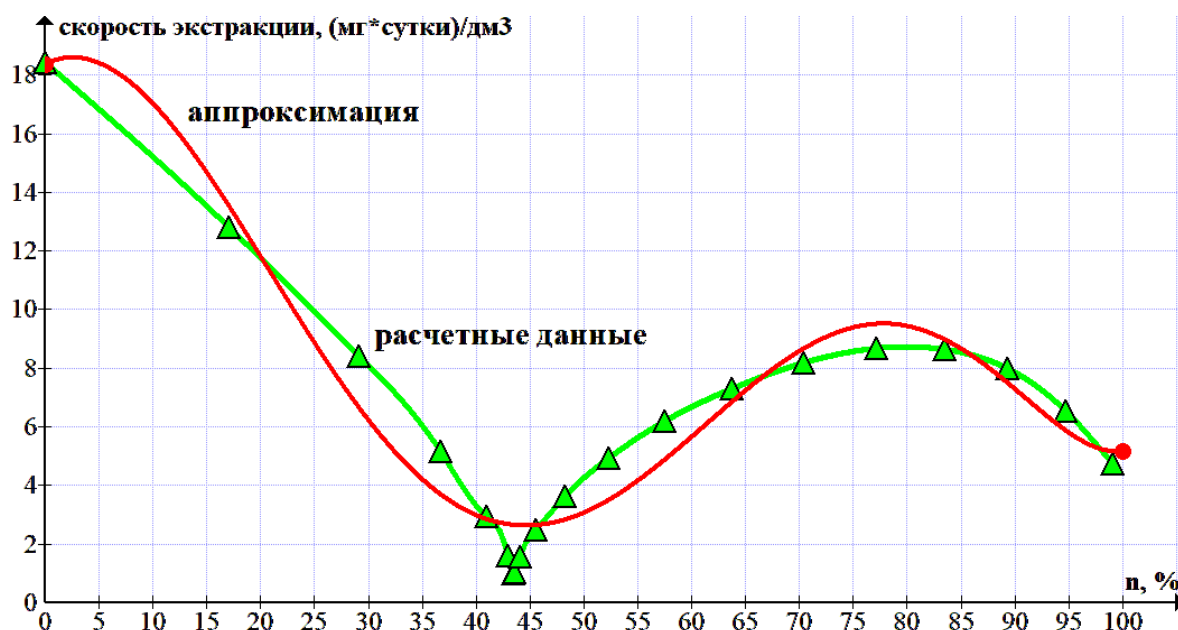
Рисунок 3.17 – Расчетная и аппроксимированная зависимости \frac{dC_x}{dT} = f(n) для висковых дистиллятов крепостью 60 % об.
