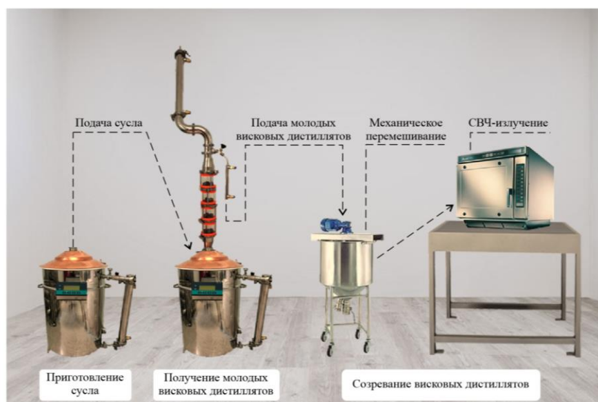
Рисунок 4.1 – Технологическая линия производства выдержанных висковых дистиллятов
