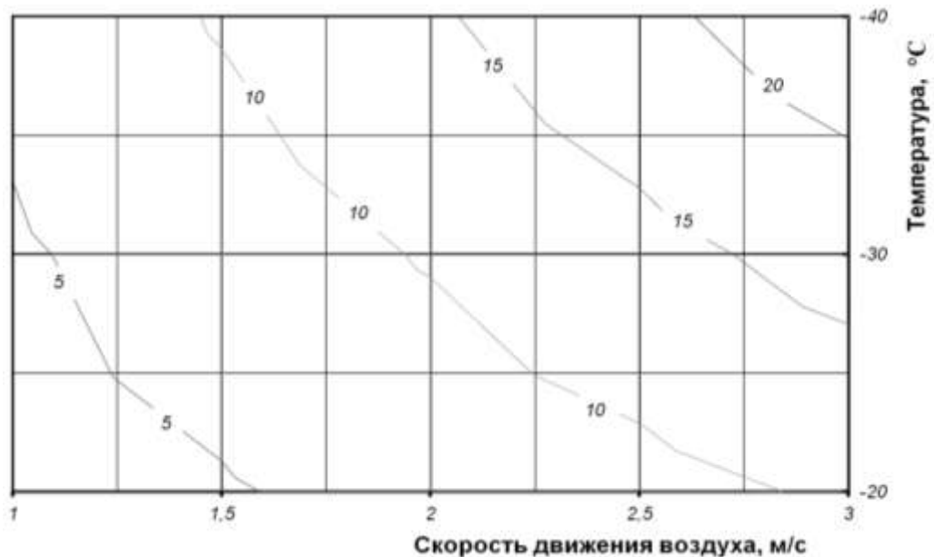
Рис. 3.20. Энергия (кДж/кг) необходимая для циркуляции воздуха в скороморозильном аппарате в зависимости от температуры и скорости воздуха
